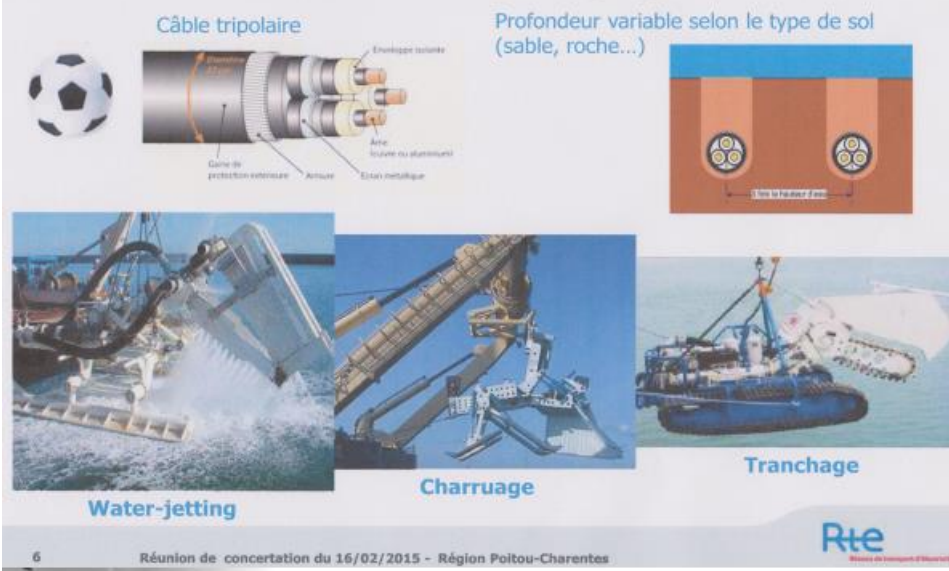
Figure 6 : câble d'atterrissage, et mise en œuvre du matériel lors de sa pose.
